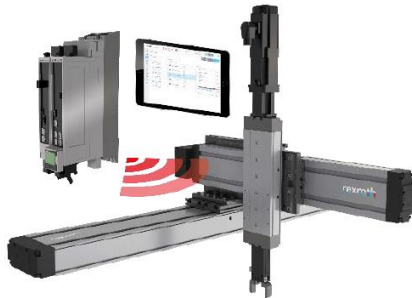
Figuur 3: Met de Smart Function Kit for Handling biedt Bosch Rexroth bovendien een systeemoplossing met één of meerdere assen voor diverse handlingtaken, die intuïtief bediend kunnen worden via Web HMI. (bron: Bosch Rexroth AG)
